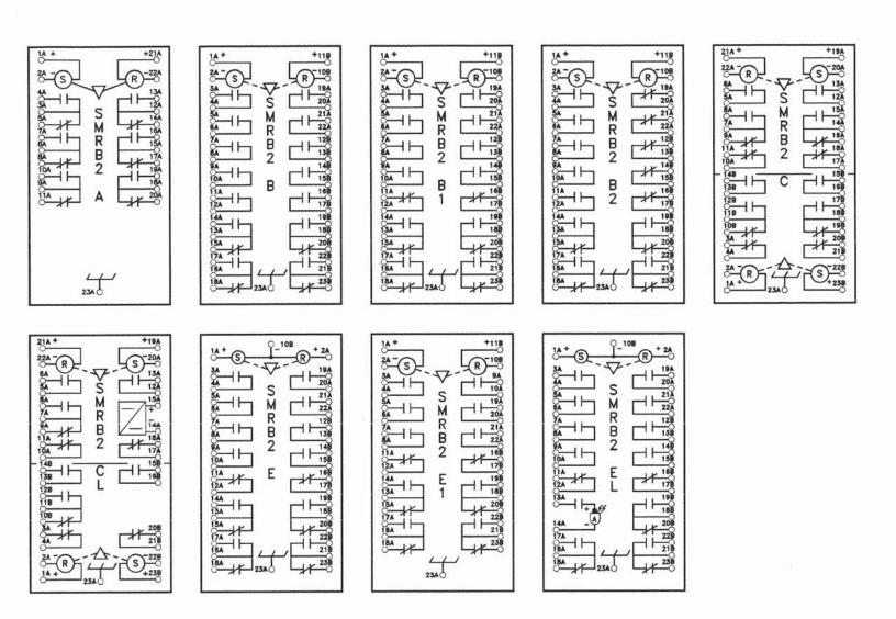
N.B.: Illustration des contacts après l'activation de la bobine de rappel R. (R = reset)
